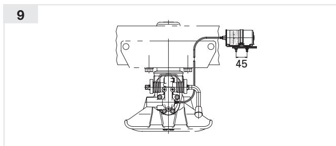
LubeTonic AK1 mit einer Schmierstelle • LubeTonic AK1 with one lubricating point • LubeTonic AK1 avec un point de graissage • LubeTonic AK1 con un punto di lubrificazione • LubeTonic AK1 con un punto de engrase
