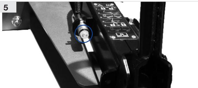
Elektrische Fernanzeige, Anzeige am Heck (RI-BR) • In-cab status indicator, display at the rear (RI-BR) • Affichage à distance électrique, affichage à l'arrière (RI-BR) • Segnalatore elettronico, segnalatore posteriore (RI-BR) • Teleindicación eléctrica, monitor en la parte trasera (RI-BR)
